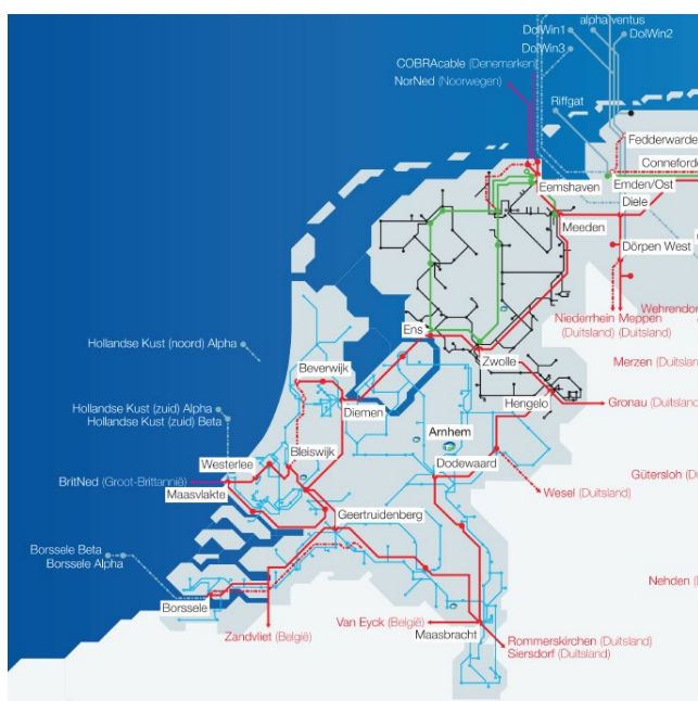
Figuur 4.14 Transmissienetwerk en interconnectoren (Bron: TenneT)
